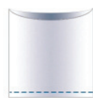
Soudure de fond droite
