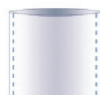
Soudure de côté
