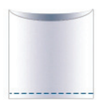
Soudure de fond droite
